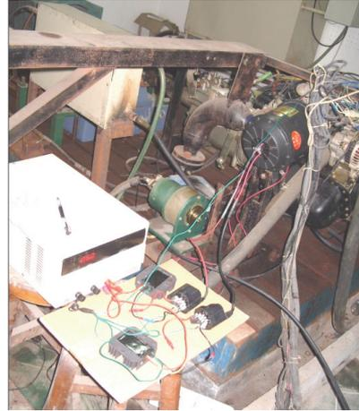
图 3.21 高压电源装置实物图
