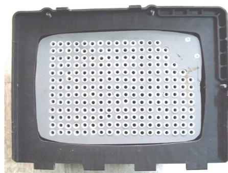
图 3.3 安装了磁化组的空气滤清器实物图
